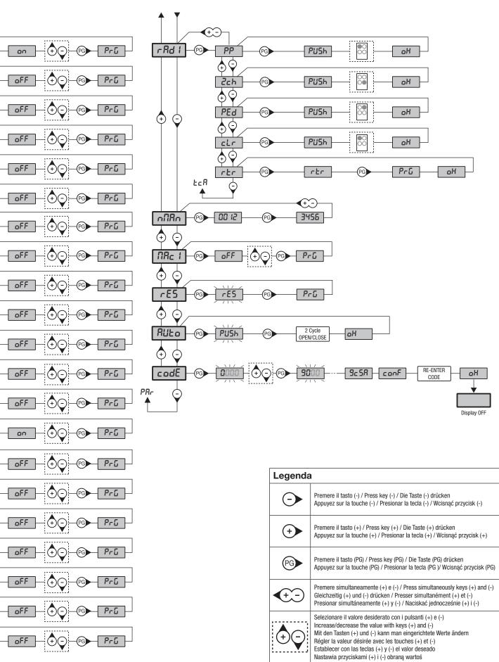
●0 00 Selezionare il pulsante del trasmettitore da associare alla funzione Press the transmitter key, which is to be assigned to function Taste des Sendegeräts drücken, dem diese Funktion zugeteilt werden soll. Appuyer sur la touche du transmetteur qu'e l'on désire affecter à cette fonction. Presionar la tecla del transmisor que se desea asignar a esta función. Wcisnąć przycisk nadajnika, który zamierza się skojarzyć z tą funkcją.
