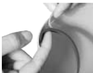
Installation der Dichtung
