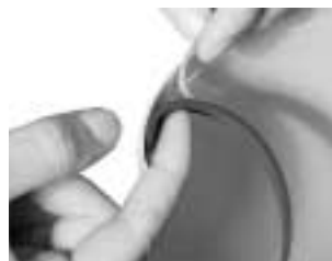
Installation der Dichtung
