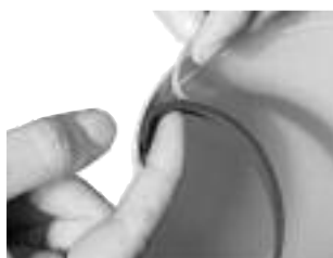
Installation der Dichtung
